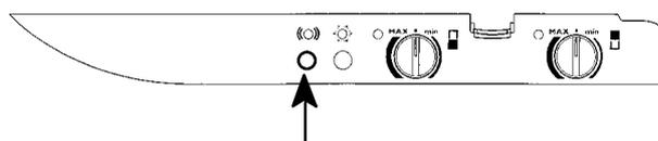
Во избежание ошибочных аварийных сигналов, при нормальном использовании существует задержка в срабатывании аварийного звукового сигнала.
