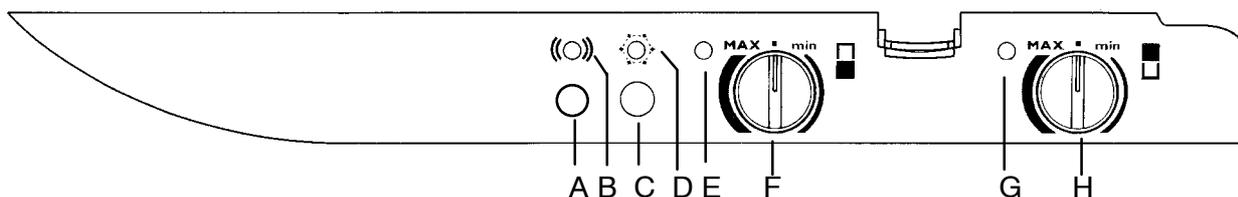
**A Кнопка сброса аварийного звукового сигнала**
